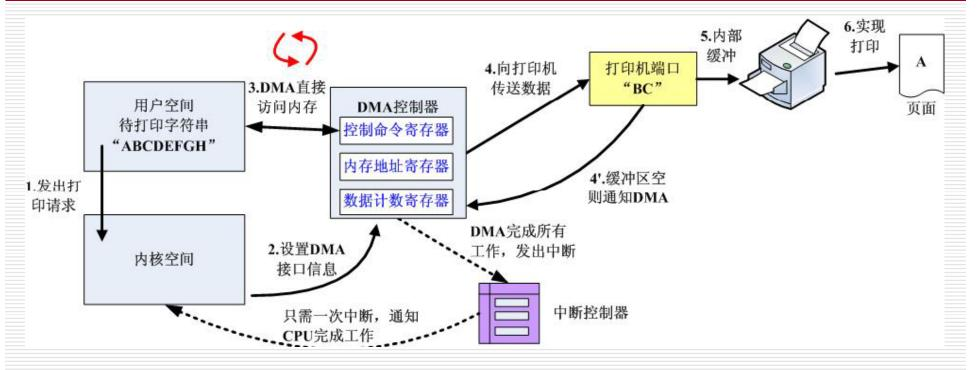
□ 用户进程发出系统调用后进入阻塞态, CPU直接设置DMA端口
