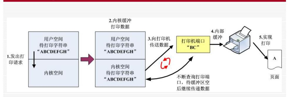
□ 由操作系统的"服务程序"负责将用户数据传送至打印机端口
