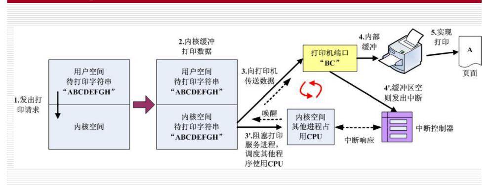
□ "打印服务程序"只将最开始的数据传送至打印机端口,然后阻塞
